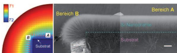
**Ganz gerade:** Ein einfacher und robuster Mechanismus richtet die Wachstumsrichtungen von Nanodrähten mithilfe eines lokalen Temperaturgradienten als lokaler kinetischer Variable während eines üblichen Dampf-flüssig-fest(VLS)-Wachs-
